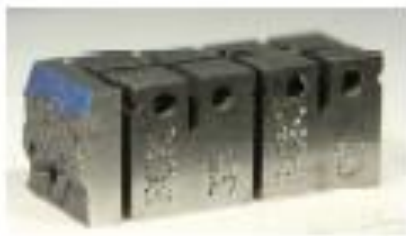
Мініатюрні С(Т) зразки, що вирізані з половинки випробуваного зразка Шарпі.
