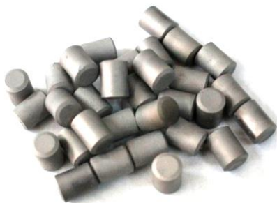
Внешний вид и микроструктура топливных таблеток.
