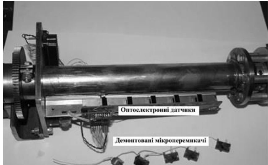
Рис. 3. Модернізований механізм переміщення мішеней.
