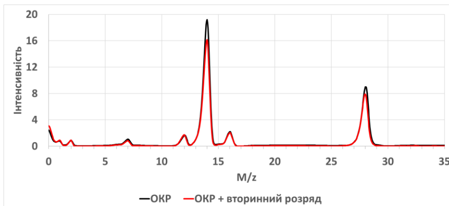
Рис. 2. Мас-спектри синтез газу отриманого лише за роботи ковзного розряду (ОКР) та за роботи вторинного розряду, який підтримується ковзним (ОКР + вторинний розряд).
