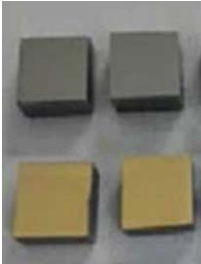
Рис. 1. Зразки Cd_{1-x}Zn_xTe ( x \sim 2\% ), E50A1 (C1-C4), з контактами Au.
