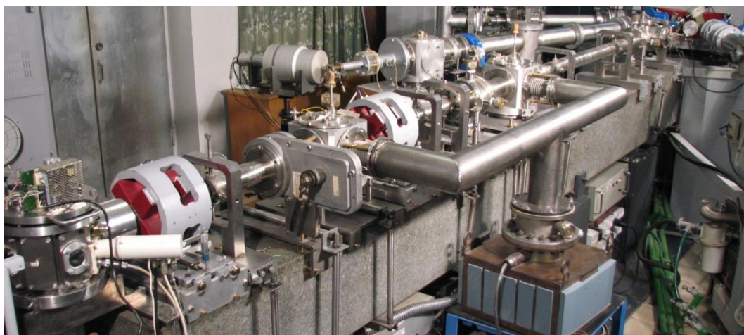
Рис. 1. Загальний вигляд ядерного скануючого мікросонда у складі аналітичного прискорювального комплексу ІПФ НАН України.
