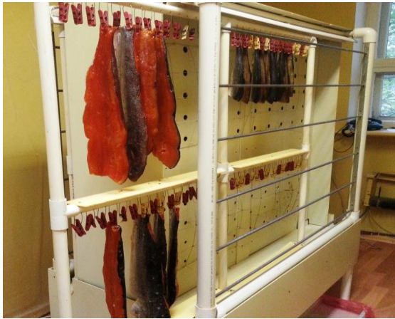
Рис. 5.43 Просолені заготовки для пресервів з філе різної риби опромінюється потоками аероіонів зі щільністю до 20 \text{ нА} \cdot \text{см}^2
