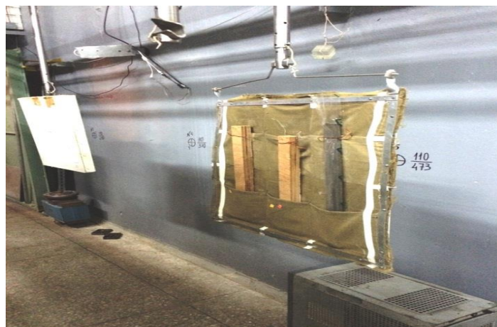
Рис. 6.27 Радіаційна обробка зразків на конвеєрі радіаційної установки СРТ
