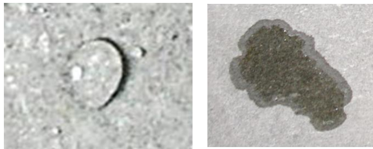
Рис. 6.19 Визначення ефективності радіаційно-хімічної гідрофобізації шиферу Зліва – крапля на модифікованому шифері (через 10 хвилин) Справа – крапля води на звичайному не модифікованому шифері (при нанесенні)
