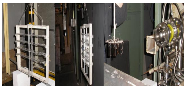
Рис. 6.6. Доопрацювання транспортної лінії і обладнання реакційно камери додатковими під пучковими засобами групового опромінювання
