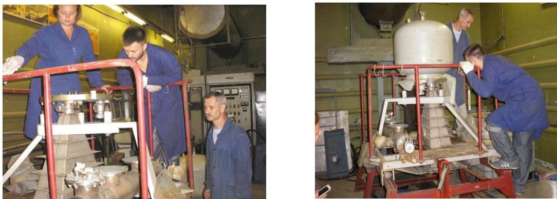
Рис. 3.9 Монтаж прискорювача електронів низької енергії
