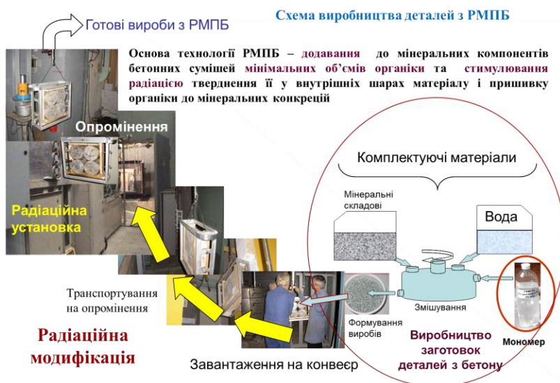
Рис. 6.10. Технологічна схема виробництва деталей з РМПБ на радіаційному комплексі ІЯД НАН України
