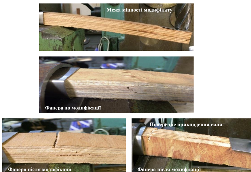
Рис. 6.36 Фотографії переломів при дослідженнях межі міцності при згинанні
