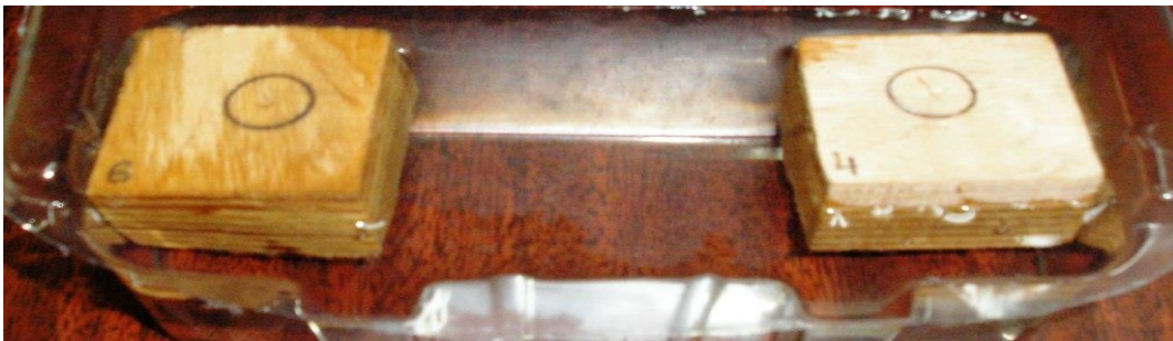
Рис. 6.34 Оцінка експлуатаційних можливостей модифікованої (4) і звичайної (6) фанери в умовах інтенсивної дії вологи
