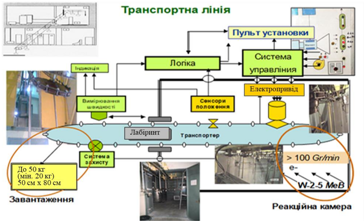
Рис. 2.9 Розроблена та реалізована багатфункціональна транспортна лінія подавання на опромінення габаритних зразків великої ваги [96]
