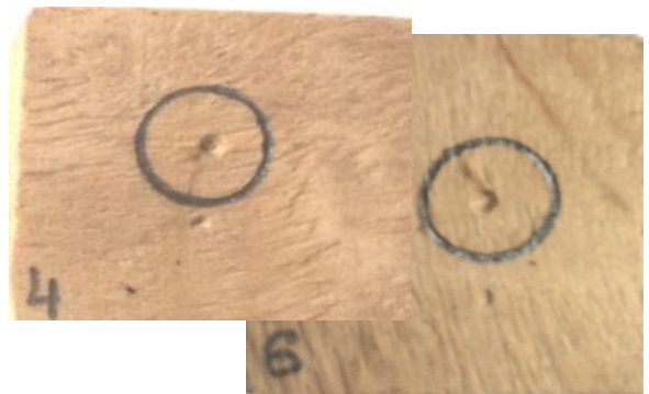
Рис. 6.38 Фото відбитків конуса 45^{\circ} з навантаженням 10 кг на поверхні зразків радіаційно модифікованої (4) і звичайної (6) фанери
