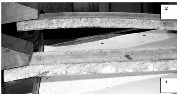
Рис. 6. 22 Випробування листового шиферу на пружну деформацію
