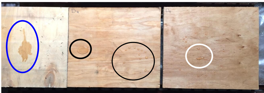
Рис. 6.33 Контроль гідрофобності зразків модифікованої фанери для промислових випробувань
