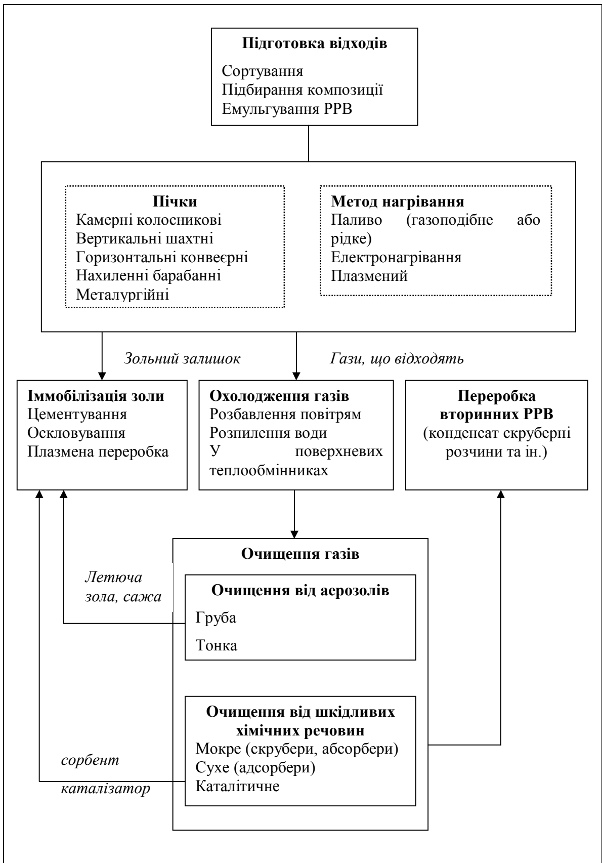
Рис. 1.6 – Принципова схема технології спалювання горючих РАВ
