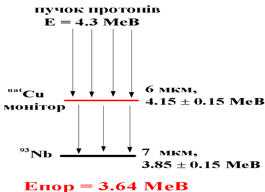
Рис. 4.14 Блок схема проведення експерименту на тандем-генераторі
