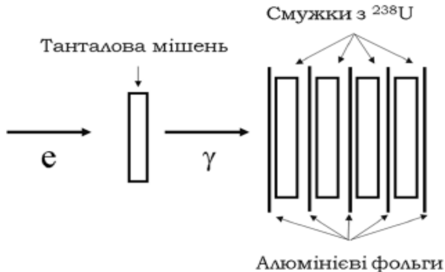
Рис. 5.2 Схематичне зображення геометрії експерименту з опромінення зразків з ^{238}\text{U} [92]
