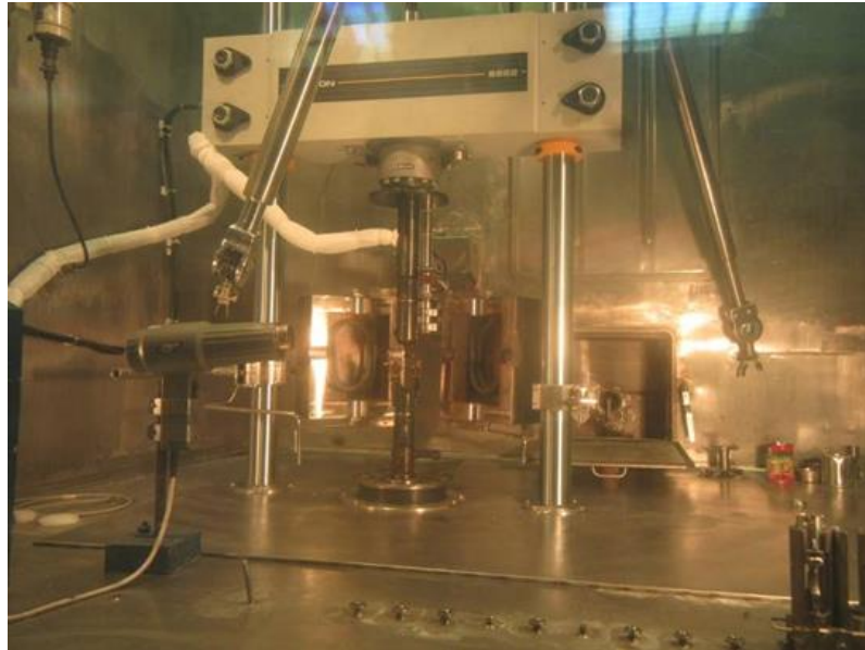
Рис. 4.4 Випробувальний комплекс Instron 8862, розміщений у захисній камері
