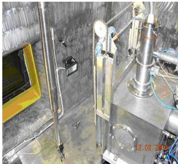
Рис. 4.17 Високовакуумна камера для електронно-променевого зварювання, розташована у захисному боксі
