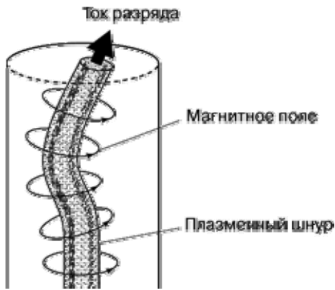
Рис. 4. Неустойчивый плазменный шнур. Силовые линии магнитного поля сгущаются с вогнутой стороны, усиливая изгиб.
