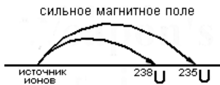
Рис.7. Схема метода электромагнитного разделения.
