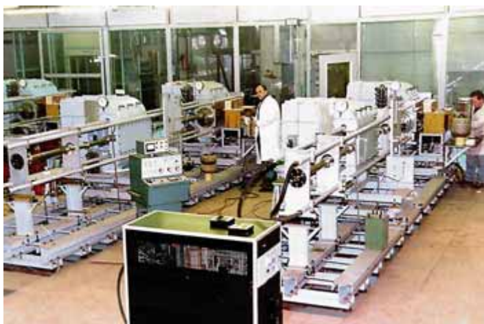
Рис. 10. Технологическая линия получения изотопа ^{13}\text{C}
