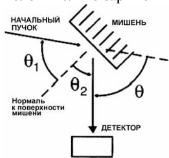
Рис. 9. Схема метода обратного резерфордовского рассеяния.
