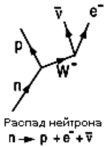
Рис. 5. Диаграмма Феймана для распада нейтрона, демонстрирующая участие W^- -мезона, как переносчика взаимодействия
