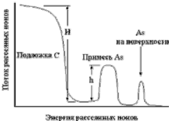
Рис. 19. Типичный спектр обратного резерфордского рассеяния гелия для углерода с поверхностно легированным и имплантированным мышьяком
