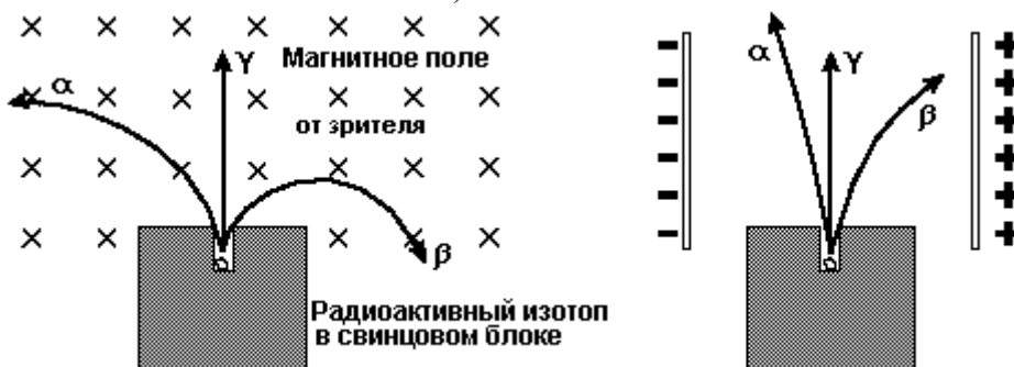
Рис.1б. Радиоактивное излучение в магнитном (слева) и электрическом (справа) полях.
