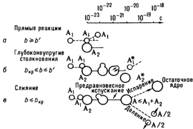
Рис. . Классификация реакций с тяжёлыми ионами по значению прицельного параметра b и времени протекания реакции.
