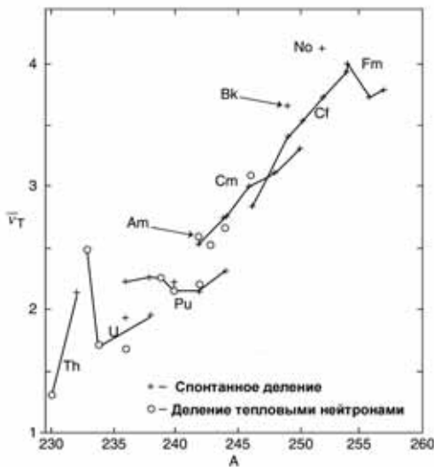
Рис. 33. Среднее общее число нейтронов \nu_T как функция массового числа делящейся системы спонтанного деления и деления тепловыми нейтронами. Значения для деления тепловыми нейтронами скорректированы на нулевую энергию возбуждения (спонтанное деление), d\nu/dt=0,12 МэВ ^{-1} .
