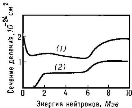
Рис. 19. Зависимость сечения деления ^{235}\text{U} (1) и ^{238}\text{U} (2) нейтронами от их энергии
