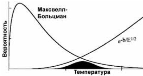
Рис. 13. Скорость солнечной нерезонансной ядерной реакции как функция температуры.
