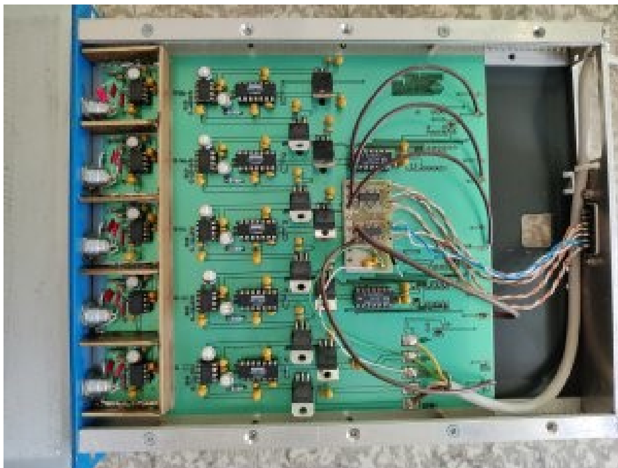
Рис. 4.6 Зарядовий інтегратор, який використовується в RMS-R3. На рисунку видно всі 5 каналів зарядового інтегратора і його компоненти, що складається у каскади, які і перетворюють струм у частоту.
