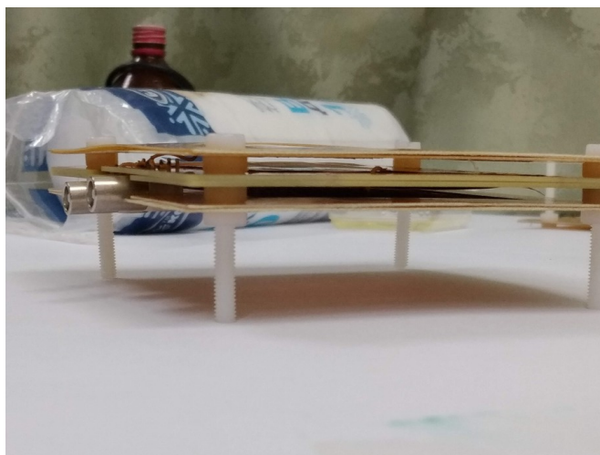
Рис. С2. Вигляд RMS-prototype4 з сенсорами 9x9 см 2 та використанням лавсану та зазором 1 мм між шарами фольг
