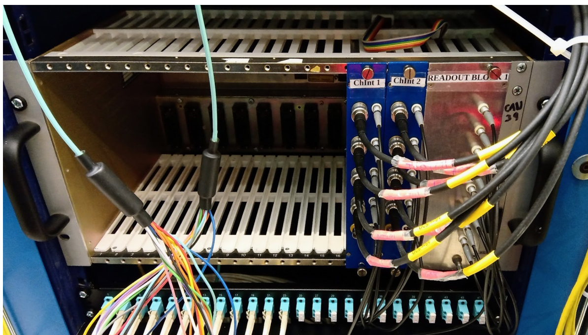
Рис. 4.26 Зверху – схематичне зображення розташування зарядових інтеграторів, лічильників та плати VLDB у NIM CRATE у Counting Room. Знизу – фото NIM CRATE з усіма компонентами зчитувальної системи RMS-R3.
