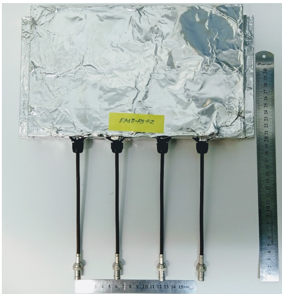
Рис. Е4. Вигляд модуля RMS-R3 у корпусі, оберненого алюмінієвою фольгою, яка заземлюється
