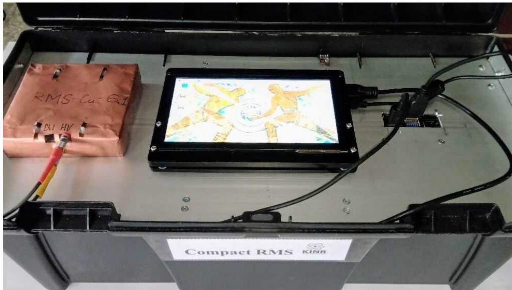
Рис. 4.11: Прототип переносного комплекту системи RMS-R3, що дозволяє виконання онлайн моніторингу та вимірювання даних.
