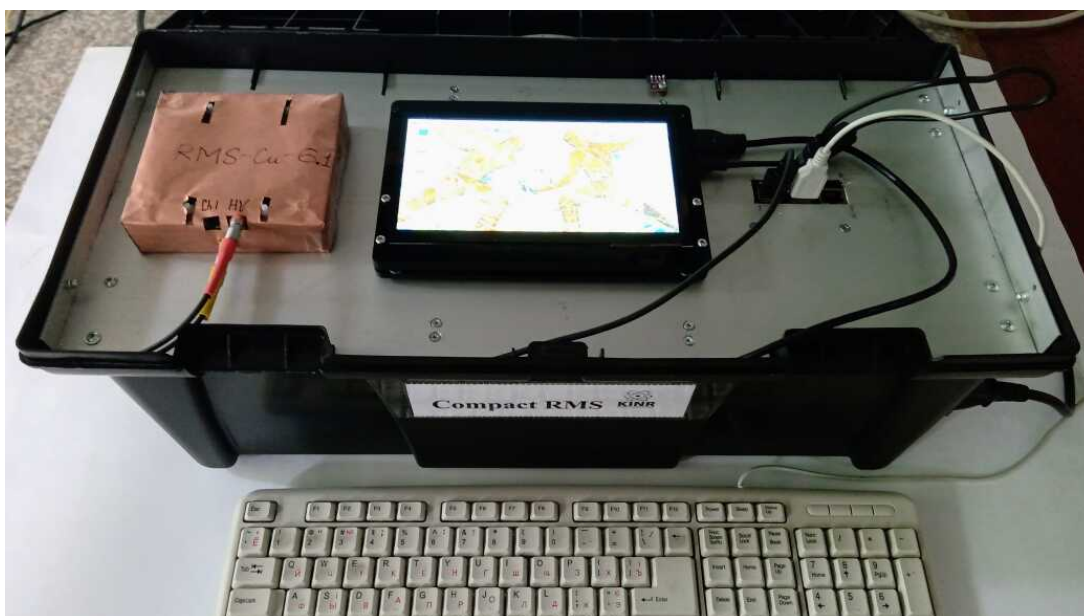
Рис. В.2: Компактна переносна система управління RMS-R3, що забезпечує автономне зчитування даних та моніторинг умов виконання дослідження.
