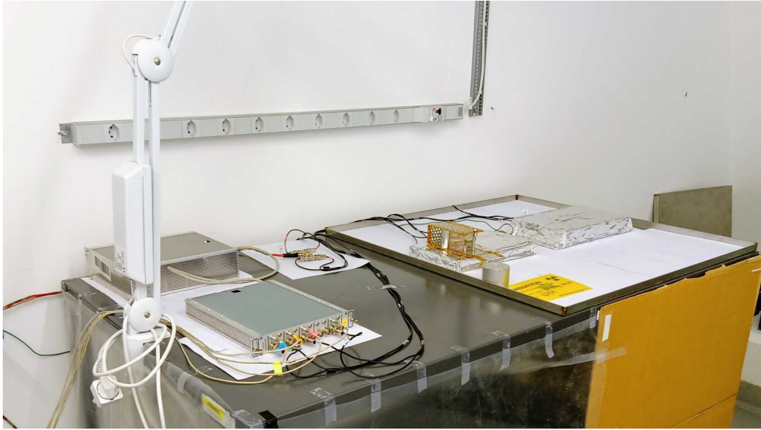
Рис. В.7: Схема розміщення калібрувального джерела, двох сенсорних модулів та блока зарядових інтеграторів системи RMS-R3, а також допоміжної коробки для розподілення напруги живлення під час тестування відгуку металевого сенсора одного із сенсорних модулів (розміщеного зліва на столі).
