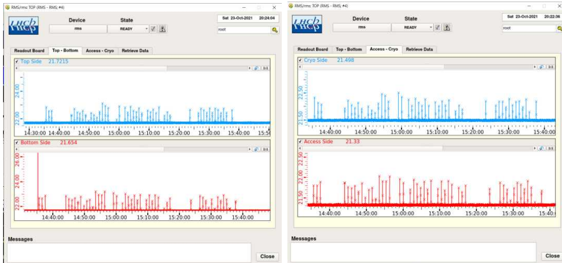
Рис. 4.15: Графіки усереднених відгуків для чотирьох пар сенсорів RMS-R3 на взаємодію щільного пучка ВАК із третинним коліматором в залежності від часу.
