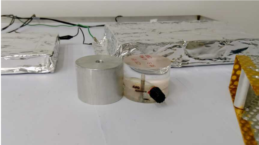
Рис. В.9: Захисний плексигласовий контейнер із коліматором, що можна відкривати/закривати за допомогою поворотної ручки, для бета-джерела (праворуч) та алюмінієвий імітатор контейнера (ліворуч), що призначений для виготовлення металевого тримача для роботи оператора.
