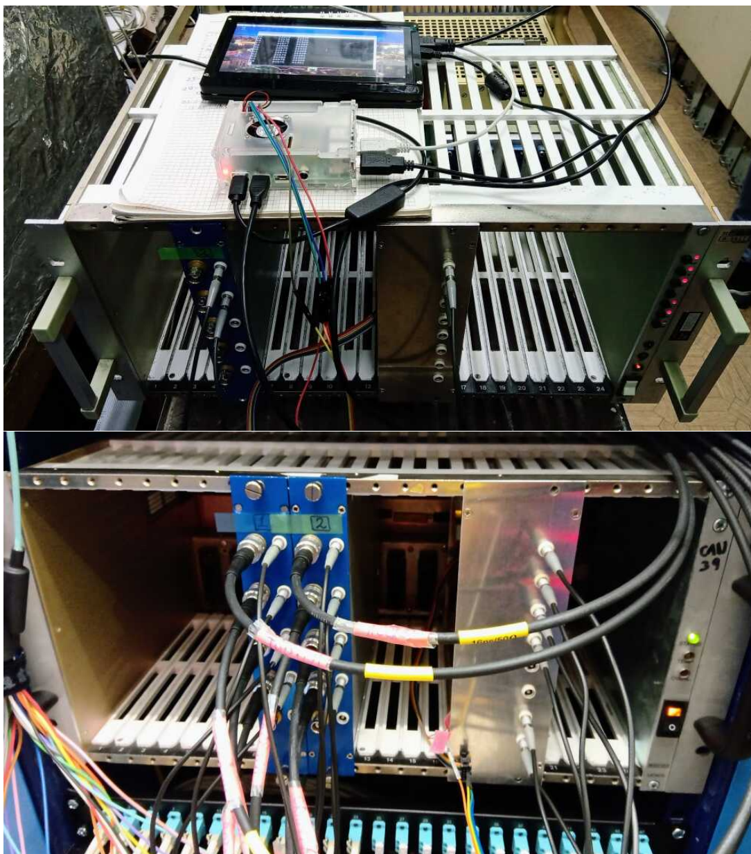
Рис. В.3: Блоки автономної електроніки системи RMS-R3, встановлені в NIM корзину, під час тестування зчитувальних каналів у лабораторії ВФВЕ ІЯД НАН України (зверху) та в приміщенні для розміщення електроніки та серверної ферми експерименту LHCb (знизу).
