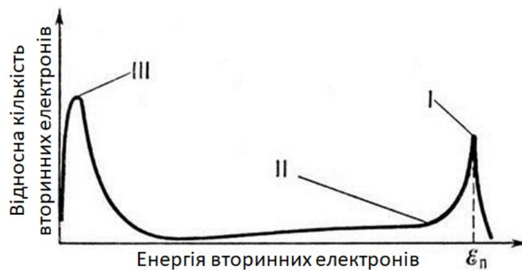
Рис. 3.3 Енергетичний розподіл вторинних електронів [124, 125]. I – пік пружно розсіяних електронів, II – спектр непружно розсіяних електронів, III – вторинні електрони [123].
