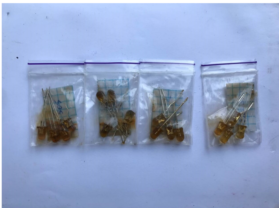
Рис. 2.14. Фото зразків, опромінених продуктами ділення (Інтегральна доза опромінення 4,5 Мрад).
