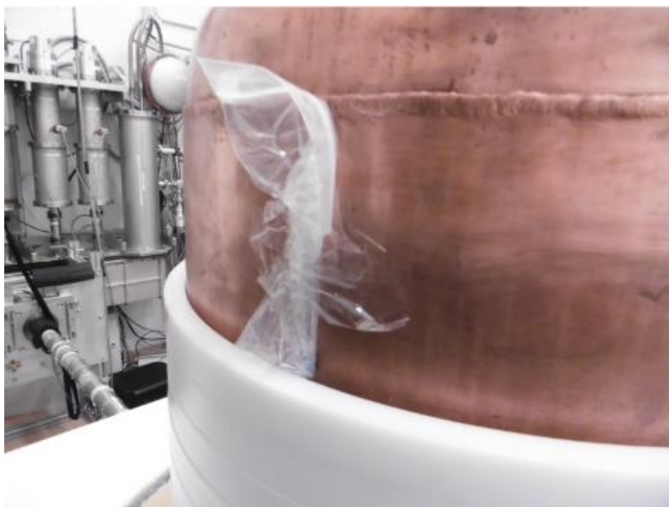
Рис. 2.3. Розташування одного з джерел ^{56}\text{Co} на зовнішньому екрані 300К кріостата EDELWEISS (на фото джерело знаходиться в прозорому пластику).
