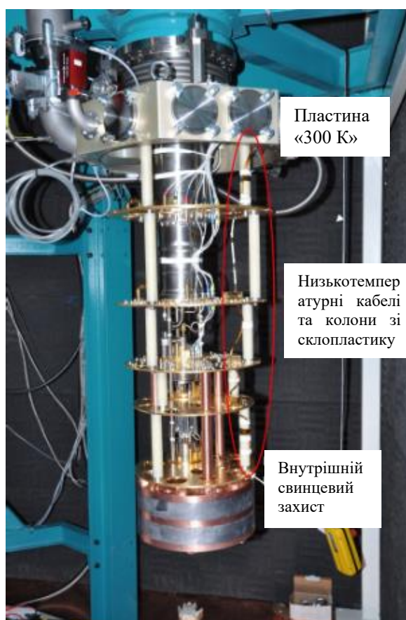
Рис. 4.5. Фотографія верхньої частини установки CROSS над внутрішнім свинцевим захистом, де зображено низькотемпературні кабелі та колони зі склопластику.
